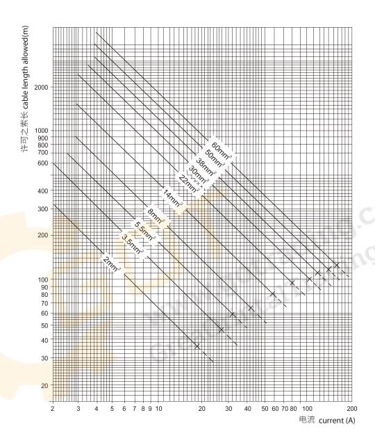
电缆应尽可能依上所示之尺寸选取用(最高环境温度30°C;在控制器与曝气机之间允许电压降为5%)。
